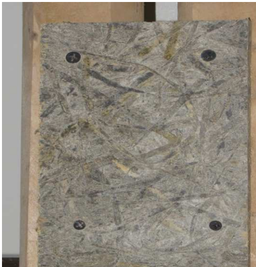
Рис.10.9. Пример крепления плиты GB-3 с использованием саморезов
