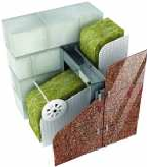
Рис. 10.14 Стеновая конструкция с применением дюбель-гвоздя
