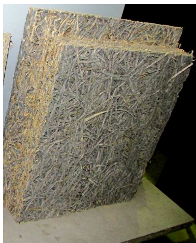
Рис.10.6. Образец фрезерованной плиты GB1 для соединения способом «в четверть»
