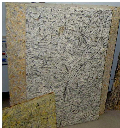
Рис.10.7. Образец фрезерованной плиты GB3 для соединения способом «в четверть»
